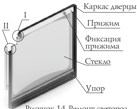
Рисунок 14. Ремонт светорозрачного экрана дверцы модели «Витра»
